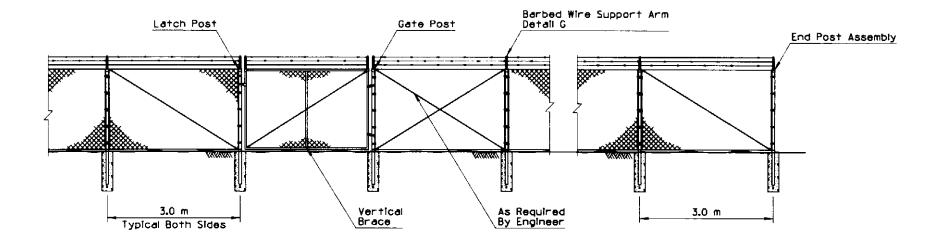
TYPICAL CHAIN LINK FENCE INSTALLATION - TYPE 2 SHOWN
