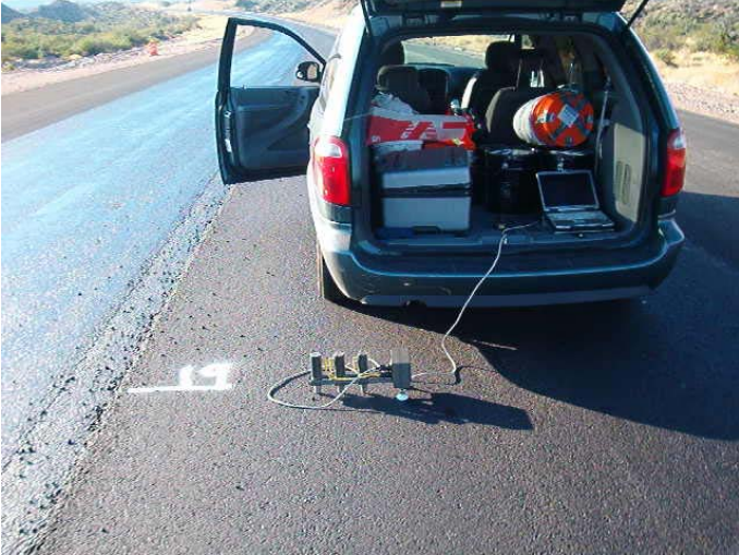
Figure N.18 – PSPA Testing on Site 6
